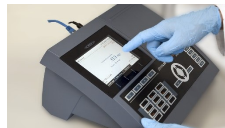
Abb.2: Ergebnis-Anzeigen für die Parameter CSB und Nitrat nach Anwenderkalibrierung mit Ergebnis- und Rohwert
