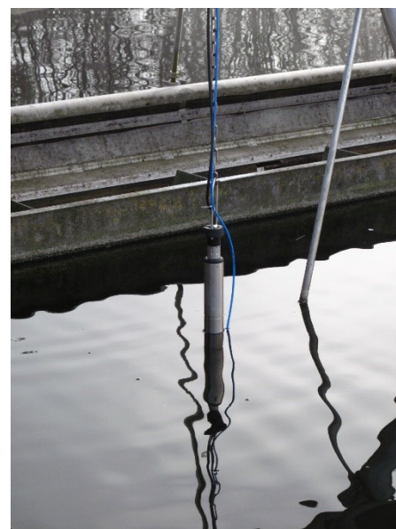
Abb. 3: Installation des Sensors NiCaVis® 705 IQ im Nachklärbecken der Kläranlage Peißenberg
