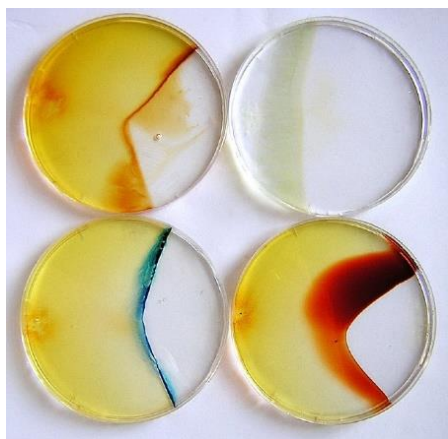
Abb. 6: Chemische Reaktionen nach Diffusion von Stoffen in der Petrischale [3]. Oben links: Eisen(III)-chlorid und Natriumhydroxid. Oben rechts: Eisen(II)-sulfat und Natriumhydroxid. Unten links: Eisen(III)-chlorid und Kaliumhexacyanoferrat(II). Unten rechts: Eisen(III)-chlorid und Kaliumthiocyanat.
