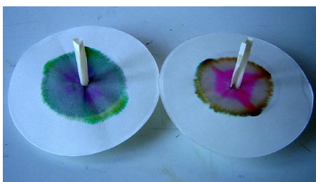
Abb. 4: Papierchromatographische Trennung der Farbstoffe in zwei verschiedenen schwarzen Filzschreibern [3].
