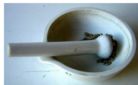
Abb. 3: Zerreiben einer Probe, hier Sonnenblumenkerne, zur Vorbereitung der Extraktion mit Petrolether [3].
