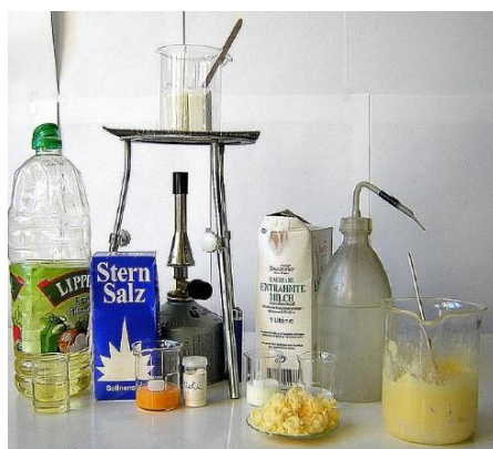
Abb. 1: Schülerarbeitsplatz zur Herstellung von Margarine. Im Becherglas rechts ist das Endprodukt [3].
