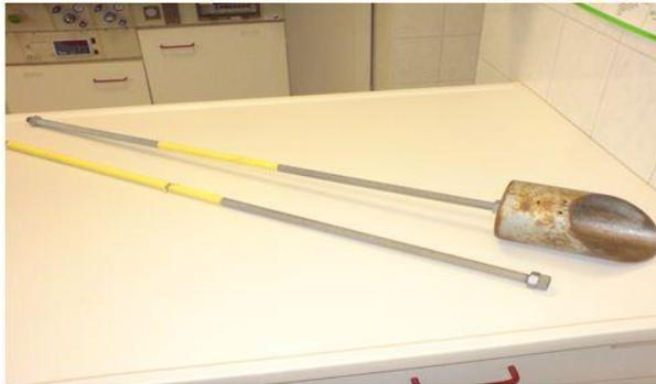
Abbildung 3: Sedimentschöpfer für die Probenahme von Flusssedimenten
