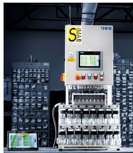
Abb. 1: Frontansicht des Lösemitteldosierstands mit Bedienpanel direkt am Apparat (oben) bzw. Fernsteuerung via Tablet (links), dem Rack mit Vials (Mitte) und den Vorlagefläschchen (unten). Auf der Rückseite des drehbar gelagerten Systems befinden sich weitere 16 Vorlagefläschchen.
