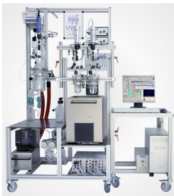
Abb. 6: Aufbau eines Kilolabors mit Laborautomatisierungssoftware
