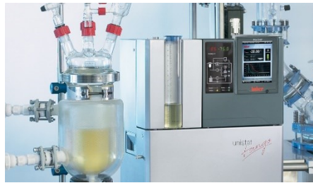
Abb. 1: Standardaufbau im Chemielabor mit Glasreaktor (Doppelmantel und Temperiergerät)
