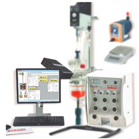
Abb. 2: Einfaches Laborautomatisierungssystem zum Messen und Regeln mehrerer Größen
