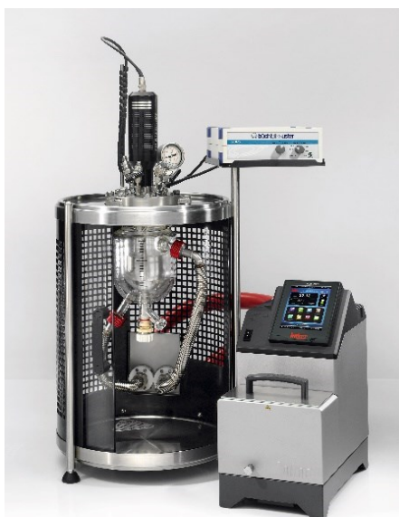
Abb. 4: Temperierung mit offenem Badthermostat
