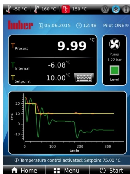
Abb. 6: Graphische Kontrolle der Prozesstemperatur unterschiedlich starker exothermer Reaktionen
