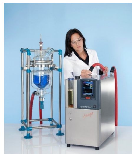
Abb. 5: Temperierung mit dynamischem Temperiergerät
