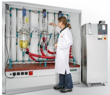
Abb. 1: Typischer Aufbau eines Temperiergerätes im Chemielabor
