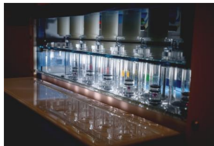
Abb. 3: In diesen sogenannten Durchflusszellen analysierte die Forscherin, wie viel Harnstoff in einem bestimmten Zeitraum aus den Biopolymer-Chips freigesetzt wurde.
