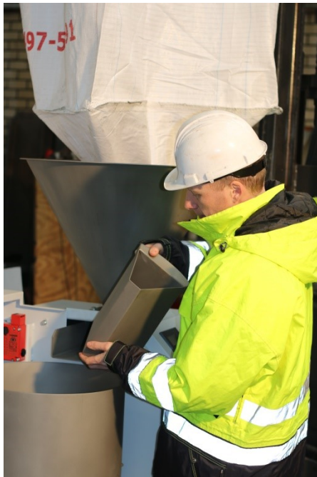
Abb. 4: Entnahme des Probenbehälters nach dem ersten Teilungsschritt
