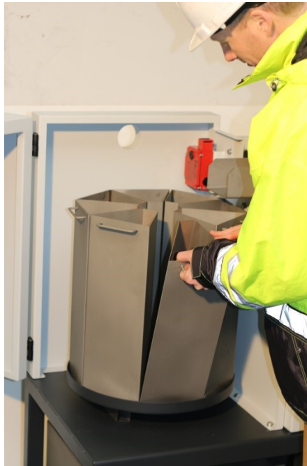
Abb. 5: Modul für den diskontinuierlichen Betrieb, mit wahlweise 6, 8 oder 10 Teilsegmenten
