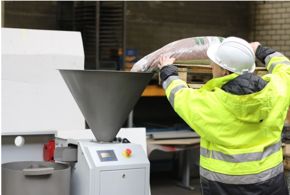
Abb. 3: Einfüllen der Probe in einen Aufgabetrichter
