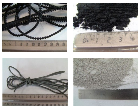
Abb. 2, 3: Reißverschluss und Kordel werden in der CryoMill vermahlen
