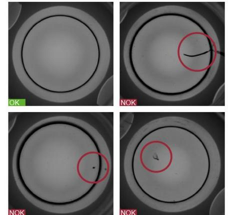
Abb.2: vial.inspect erkennt Verunreinigungen, Fremdkörper, Glasfragmente und Risse im Bereich des Vial-Bodens sicher.
