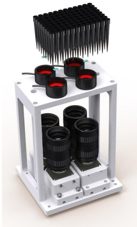
Abb3: pipette.inspect von OCTUM inspiert alle 96 Pipettenspitzen eines Racks durch den Einsatz eines speziellen Prüfkonzpts in zwei Schritten in je einer Ansicht von der Seite und von unten.
