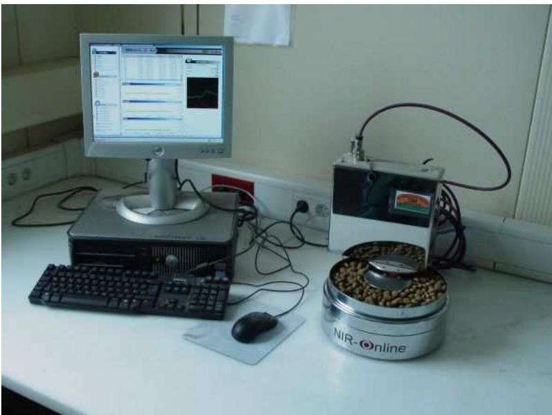
Eine weitere NIR-Online-Station ist im Labor zur Feuchtigkeitskontrolle der Hunde- und Katzennahrung im Einsatz. Das mobile Gerät besteht aus einem Drehteller mit einer großen Schale, die rund einen Liter fasst. Darüber befindet sich der NIR-Online-Sensor. Im Gegensatz zu herkömmlichen Schnell-Feuchtigkeitsbestimmern, in denen nur sehr kleine Mengen untersucht werden können,
