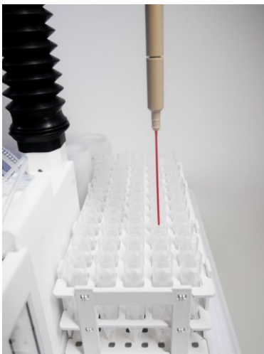
Abb. 3: Um bei ICP/AAS die Kontamination durch Metalle zu vermeiden, werden soweit möglich die Geräteteile durch Kunststoffkomponenten ersetzt. Zudem sind metallische Teile mit hochwertigen Werkstoffen wie PTFE oder Halar beschichtet. Um die Elektronik des Liquid Handling-Roboters zu schützen, wird diese abgedichtet und zusätzlich mit säuredampf-freier Luft gespült.
