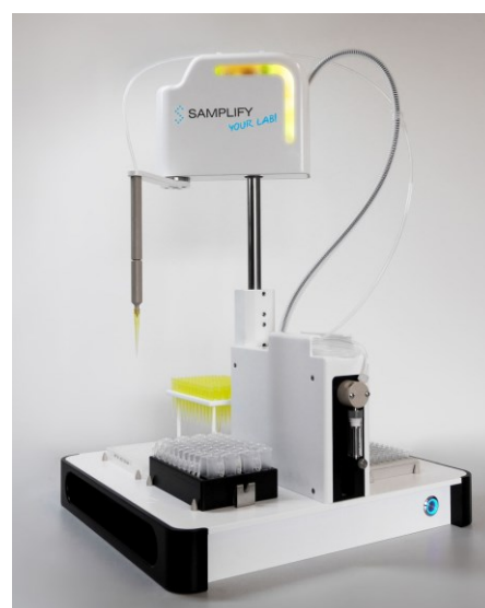
Abb.2: Der SAMPLIFY P ist mit einer stärkeren Z-Achse als das Robot-Modell ausgestattet und erreicht eine höhere Präzision bei Flüssigkeitsvolumina von 0,5 bis 20 µl. Zudem können bis zu fünf Mikrotiterplatten mit 384 Plätzen gleichzeitig bearbeitet werden. Die Einstellungen erfolgen, wie auch beim SAMPLIFY Robot, über die Script-Software. Das mitgelieferte Tablet ermöglicht bei beiden Modellen die Steuerung auch kabellos über eine Funk-Verbindung.
