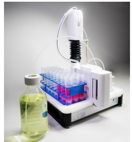
Abb. 3: Um bei ICP/AAS die Kontamination durch Metalle zu vermeiden, werden soweit möglich die Geräteteile durch Kunststoffkomponenten ersetzt. Zudem sind metallische Teile mit hochwertigen Werkstoffen wie PTFE oder Halar beschichtet. Um die Elektronik des Liquid Handling-Roboters zu schützen, wird diese abgedichtet und zusätzlich mit säuredampf-freier Luft gespült.
