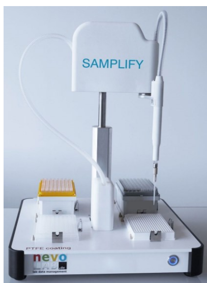
Abb.2: Der SAMPLIFY P ist mit einer stärkeren Z-Achse als das Robot-Modell ausgestattet und erreicht eine höhere Präzision bei Flüssigkeitsvolumina von 0,5 bis 20 µl. Zudem können bis zu fünf Mikrotiterplatten mit 384 Plätzen gleichzeitig bearbeitet werden. Die Einstellungen erfolgen, wie auch beim SAMPLIFY Robot, über die Script-Software. Das mitgelieferte Tablet ermöglicht bei beiden Modellen die Steuerung auch kabellos über eine Funk-Verbindung.
