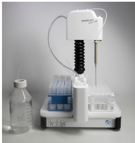
Abb. 3: Um bei ICP/AAS die Kontamination durch Metalle zu vermeiden, werden soweit möglich die Geräteteile durch Kunststoffkomponenten ersetzt. Zudem sind metallische Teile mit hochwertigen Werkstoffen wie PTFE oder Halar beschichtet. Um die Elektronik des Liquid Handling-Roboters zu schützen, wird diese abgedichtet und zusätzlich mit säuredampf-freier Luft gespült.
