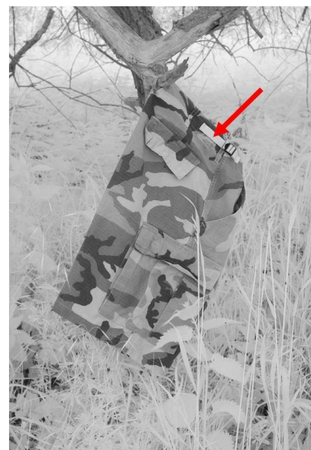
Abb. 10a: (links) Vierfarb-Flecktarn aufgenommen im Sichtbaren mit Sperrfilter. Der rote Pfeil markiert das dunkelgrüne Gurtband.
