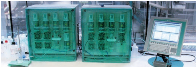
Abbildung 3: ProcessLab zeichnet sich durch die prozessnahe Durchführung der Analysen aus (Atline-Analytik). Bei MACO steht das Analysensystem direkt bei den Galvanisierbädern.
