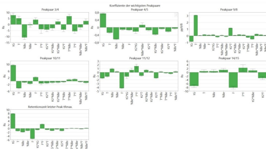
Abb. 10 Einfluss der Faktoren auf die 6 Zielgrößen der Auflösung (Rs 3/4 , Rs 4/5 , Rs 9/8 , Rs 10/11 , Rs 11/12 , Rs 14/15 ) und tRmax.
