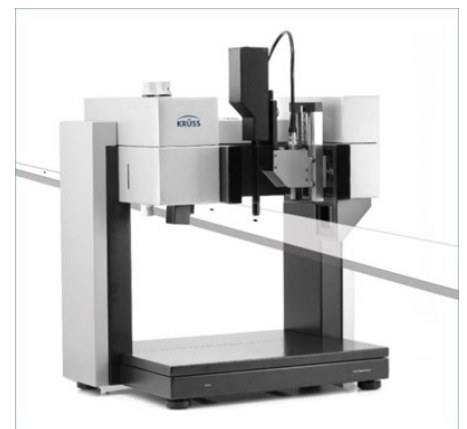
Abb. 1: Schematischer Aufbau einer Reihen-Kontaktwinkelmessung auf einer sich bewegenden Probe.
