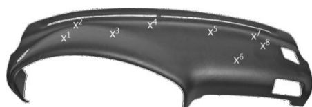
Abb. 3: Schematische Darstellung einer Armaturenabdeckungsprobe: Messungen wurden je an acht Stellen durchgeführt, welche hier entsprechend markiert sind.
