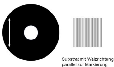
Abb. 6: Schemazeichnung der Öffnung der Integrationskugel am Reflexions-Port mit Markierung (weißer Doppelpfeil) sowie ein Substratblech mit Walzriefen.
