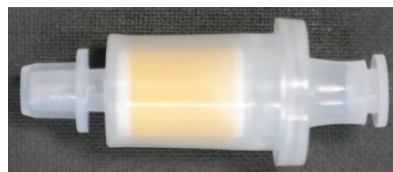
Abb. 8: DNPH-Kartusche zur Probennahme von Raumluft oder sonstigen Luftproben. Das Trägermaterial enthält bereits das Derivatisierungsreagenz 2,4-Dinitrophenylhydrazin, wie man an der gelb-orangen Farbe erkennt.
