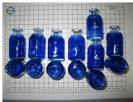
Abb. 1: Typ III-Flaschen mit durch Methylblau visualisierter Korrosion
