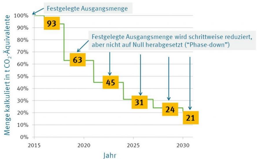
Abb. 1: Der Phase Down definiert die Höchstmengen (in Prozent) für das Inverkehrbringen von teilfluorierten Kohlenwasserstoffen (HFKW) in den Jahren 2015 bis 2030. (Quelle: Umweltbundesamt)
