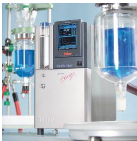
Abb. 3: Bei kompakten Laborgeräten, wie dem Petite Fleur, sind natürliche Kältemittel längst Standard. Aufgrund der geringen Füllmenge sind keine Sicherheitsmaßnahmen von Seiten des Betreibers erforderlich.
