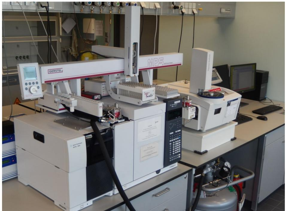
Abb. 1: Aufbau des TED-GC/MS ©BAM
