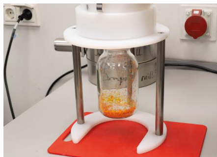
Abb. 3: Probenaustrag im Probenglas des Kleinmengenzylons
