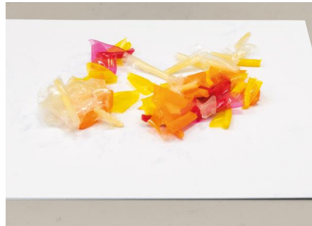
Abb. 1: Latex vorzerkleinert auf 1 cm
