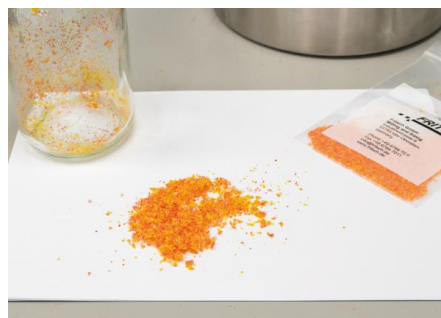
Abb. 4: Endfeinheit der zerkleinerten Latexprobe < 1 mm
