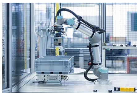
Abb. 4: Maschinelles Lernen macht den Griff-in-die-Kiste autonomer, schneller und robuster.
