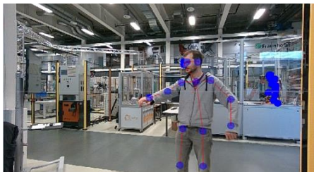
Abb. 3: Die »Robo-Dashcam« erfasst datenschutzkonform sicherheitsrelevante Daten und Personen, während die Roboterzelle in Betrieb ist. So kann das Sicherheitskonzept auch nachträglich noch angepasst werden.
