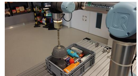
Abb. 5: Das roboterbasierte »Bin Packing« nutzt den vorhandenen Platz optimal.
