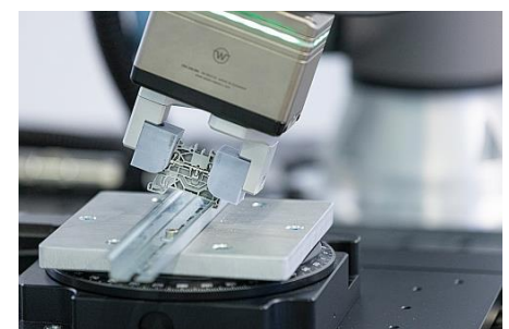
Abb. 6: Mit »pitasc« wird die Montageautomatisierung auch bei hoher Variantenvielfalt wirtschaftlich umsetzbar.
