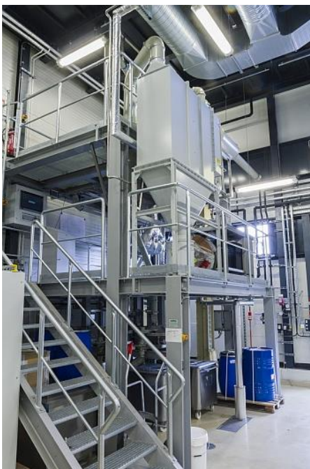
Abb. 4 In der Schälanlage (links) können im kontinuierlichen Betrieb bis zu 100 Kilogramm Rapssamen pro Stunde geschält werden.
