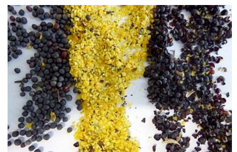
Abb.2: In der Schlanlage wird die Rapssaat (links) zunchst aufgebrochen und die leichteren Schalen (rechts) von den schwereren Kernen (Mitte) getrennt.
