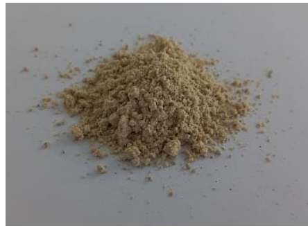
Abb. 3: Das in der EthaN a -Pilotanlage gewonnene Rapskernkonzentrat enthält über 40 Prozent hochwertige Proteine
