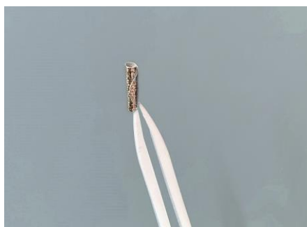
Abb.3: Erste Wickelversuche der Festelektrolytbeschichtung zur Charakterisierung der Beschichtungsqualität.
