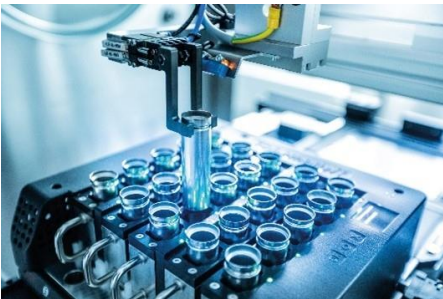
Abb. 5: Assemblierung von Batteriezellen mit einem intelligenten Werkstückträger für die digitalisierte Produktion.
