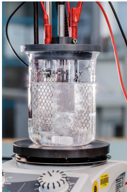
Abb. 1: Versuchsaufbau zur Abscheidung von Iridium-haltigen Schichten.
