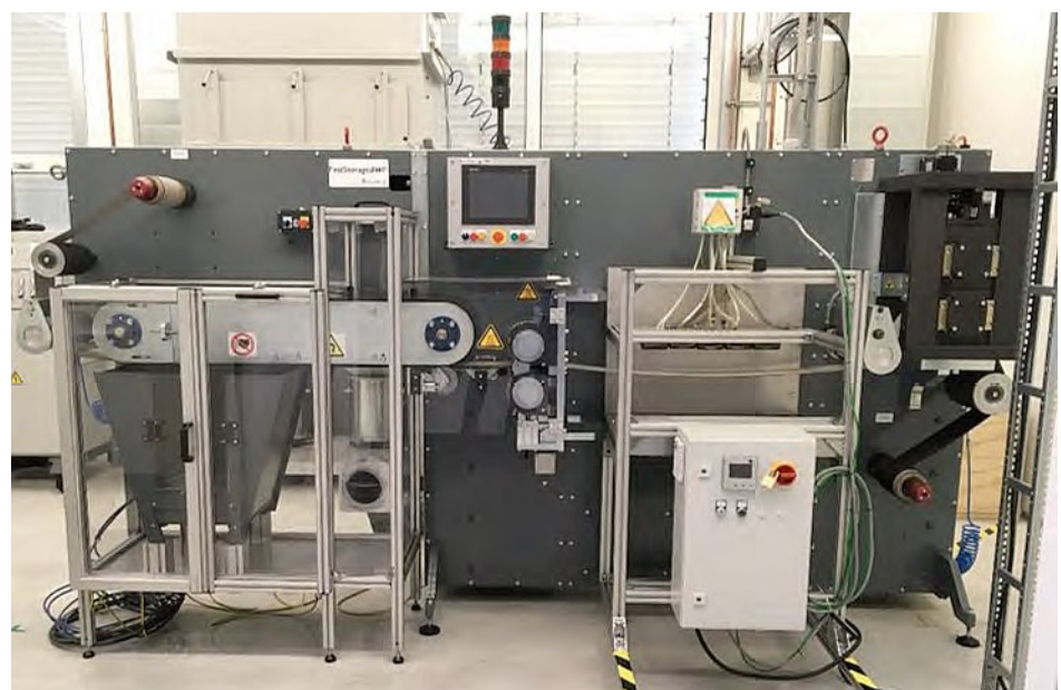
Abb. 5: Kompakte Anlage zur Trockenbeschichtung von Batteriespeicherelektroden
