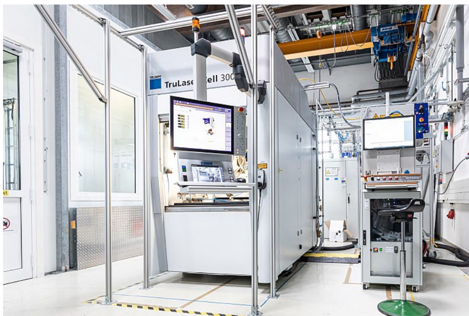
Abb. 6: Laserschweißen in der Batteriezellenproduktion
