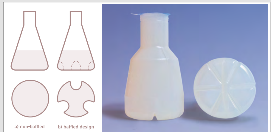
Abb. 1 (von links nach rechts): Erlenmeyerkolben traditionell (ohne Schikanen), mit Schikanen, Ultra Yield Kolben
