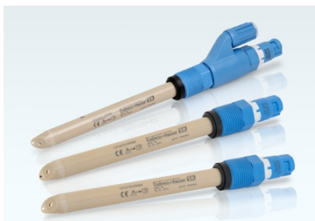
Abb. 2: ISFET-Sensoren (von oben nach unten) Memosens CPS47D mit Keramikdiaphragma und Flüssig-KCl-Referenz Memosens CPS97D mit Lochdiaphragma und gelgefüllter Referenz Memosens CPS77D mit Keramikdiaphragma und gelgefüllter Referenz
