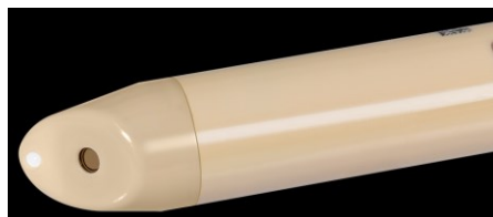
Abb. 3: Die neue ISFET-Generation: vergrößerte Chipfläche und ebene Einbettung des Chipgates reduzieren Verschmutzungsgefahr und verbessern die Reinigbarkeit
