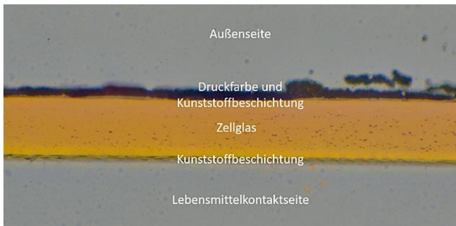
Abb. 3: Mikrotomschnitt (400x Vergrößerung) einer bedruckten und auf beiden Seiten dünn mit einem Kunststoff beschichteten Zellglasfolie
