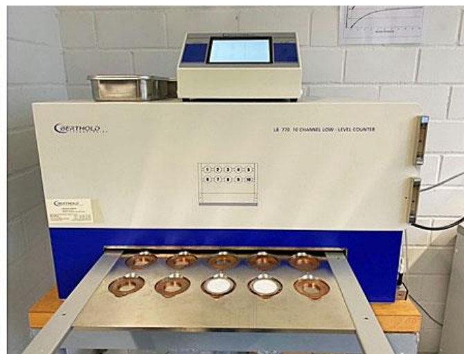
Abb. 2: (links) Säulen zur Sr-90-Aufarbeitung mit einem Sr-spezifischen Harz Abb. 3: (rechts) Low-Level-Beta-Counter zur Messung von Beta-Strahlern. Geöffnete Schublade mit 10 Messplätzen, davon 2 mit Präparateschälchen belegt
