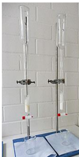
Abb. 2: (links) Säulen zur Sr-90-Aufarbeitung mit einem Sr-spezifischen Harz Abb. 3: (rechts) Low-Level-Beta-Counter zur Messung von Beta-Strahlern. Geöffnete Schublade mit 10 Messplätzen, davon 2 mit Präparateschälchen belegt
