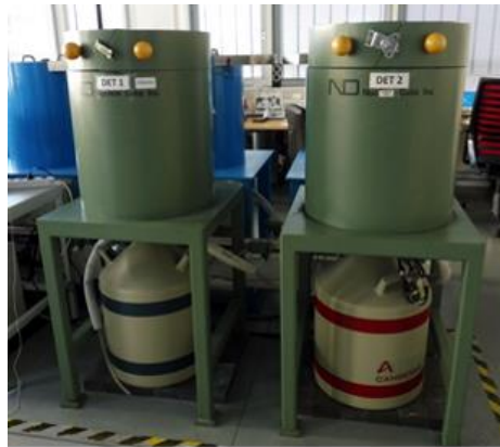
Abb. 3: (links) Gamma-Messplätze mit darunter befindlichen Dewar-Gefäßen mit Flüssigstickstoff zur Kühlung der Germanium-Detektoren
