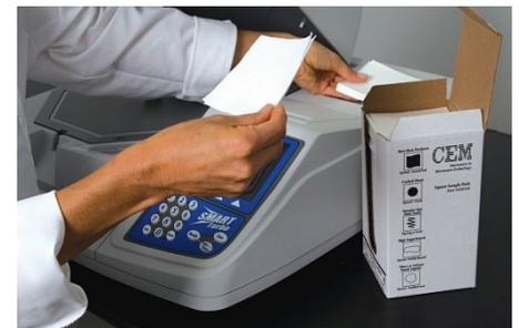
Abb.2: Probenträger für das Smart Turbo
