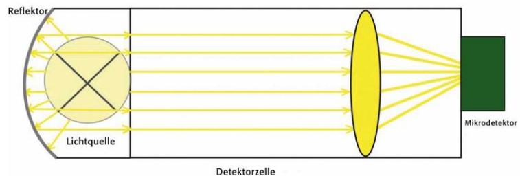
Abb. 1: Schematischer Aufbau des FR-NDIR Detektors: Extrem robust ausgelegt, da im messgasdurchströmten Teil die Strahlenausbeute komplett reflexionsunabhängig ist. Daher tritt kein Empfindlichkeitsverlust durch eventuelle Wandablagerungen auf und der Aufbau ist durch den Einsatz inerter Materialien praktisch korrosionsfrei.
