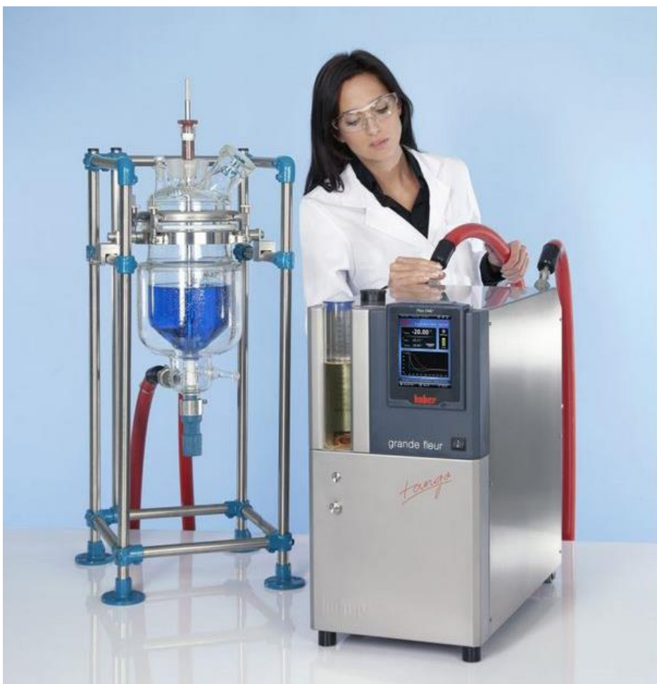
Abb. 4: Beim Anschluss sollte darauf geachtet werden, dass geeignete Schläuche verwendet werden und dass diese nicht gequetscht werden
