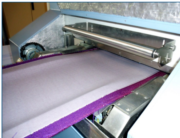
Abb. 1: Beschichtete Ware am Auslauf des Trocknungsabteils des Mathis-Laborfoulards /Göb/
