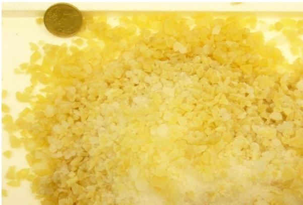
Dieser Rohkautschuk lässt sich manuell nur mit Schneidwerkzeugen unter hohem Aufwand zerkleinern. Eine Versprödung mittels flüssigem Stickstoff ermöglicht die Zerkleinerung kleiner Mengen mit der [Kraft-Schneidmühle PULVERISETTE 25](#). Viel eleganter und auch für größere Mengen sehr gut geeignet ist die Versprödung und das gemeinsame Mahlen mit Trockeneis in der PULVERISETTE 25.
