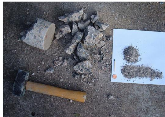
Prinzipiell sollte für Eluat die Korngröße genutzt werden, die der weiteren Verwendung entspricht. Da aber Betonbruchstücke, wie oben im Bild zu sehen, nicht analysiert werden können, geht man in diesen Prüfungen von rund 10 mm aus; für andere Prüfungen
