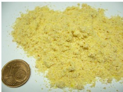
Die Sieb-Analyse zeigte, dass 89 % < 0,5 mm und damit nur noch 11 % > 0,5 mm sind. Dies erklärt sich durch die unterschiedliche Form der Siebe und auch dadurch, dass in der Mühle durch die hohe Rotordrehzahl die Partikel beschleunigt und dann regelrecht durch das Sieb hindurch geschossen werden. Die Maiskörner lassen sich auch bei Verwendung eines 0,2 mm Siebes noch zerkleinern.
