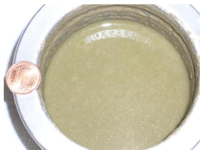
Diese Verfahrensweise ist aufwendiger und bringt optisch beurteilt ein nicht ganz so homogenes Endprodukt. Alles entscheidend sind aber die Vergleichbarkeit der CSB-Werte mit älteren Werten und die Korrelation zu den in den Laborversuchen erzeugten Methanmengen.
