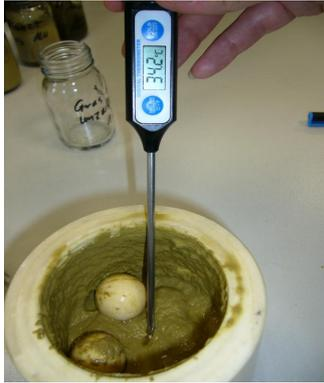
Der Silage wurde in den Versuchen Pufferlösung zugesetzt. Damit wurde der Feststoffgehalt erniedrigt. Nach 4 Minuten war das Material extrem gut zerkleinert. Auch die Messung der Temperatur zeigte normale Werte an. Es war also nicht mit einer thermischen Schädigung zu rechnen. Die ermittelten CSB-Werte waren aber deutlich verschieden von den CSB-Werten der Proben, die mit den bisherigen Zerkleinerungsverfahren vorbereitet waren.
