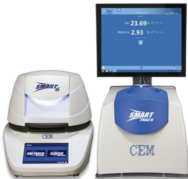
Das Smart 6 kann erweitert werden für die Fettbestimmung. Diese dauert nur 8 s. und ist kalibrationsfrei.
