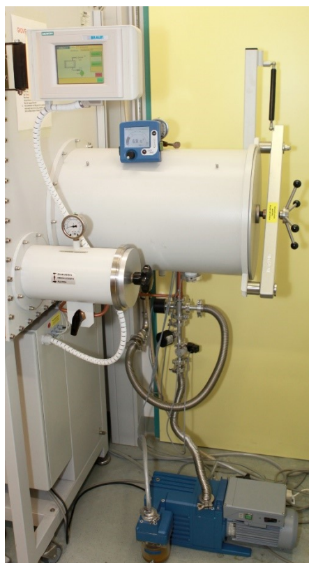
Abb. 2: Transferkammern einer Glovebox-Anlage mit Vakuumpumpe und Vakuummessgerät
