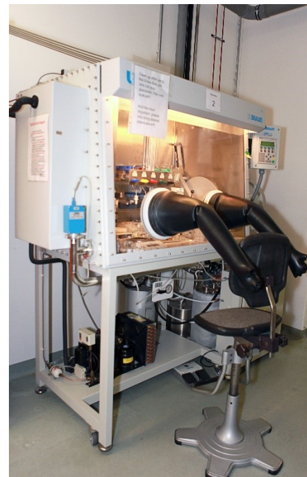
Abb. 1: Glovebox-Anlage an der Universität Bremen mit Kühlkammer und Einrichtung zur Lösemittelentnahme
