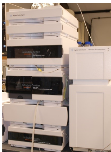
Abb. 1: Links: Analytische SFC (Agilent Technologies) im Labor der AFG. Der Aufbau ist sehr ähnlich zu einer 1260 Infinity HPLC. Das Gerät auf der rechten Seite der HPLC ist das Backpressure Module (Aurora), welches die Verwendung von CO 2 als mobile Phase möglich macht.
