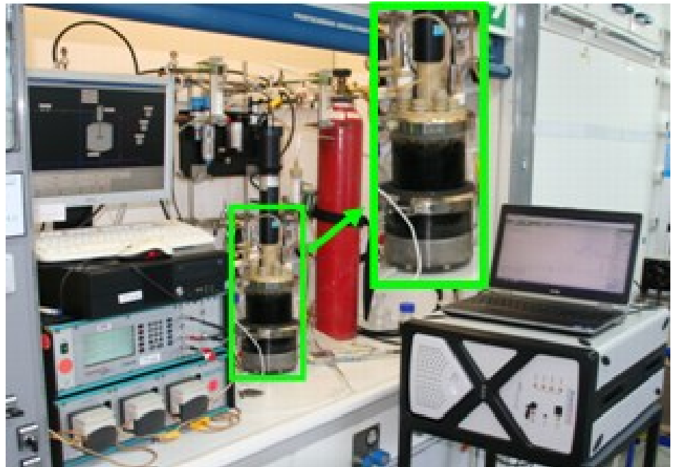
Abb. 1: Laboraufbau. Hervorhebung: 2L-Laborfermenter.
