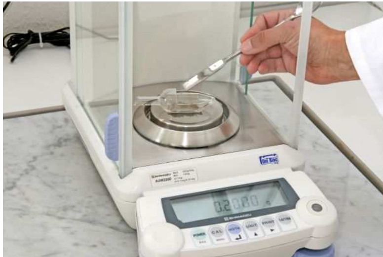
Bild 1: Die vorzerkleinerte Feststoffprobe wird eingewogen
