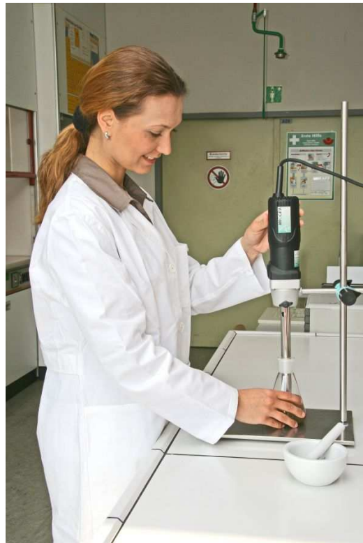
Bild 2: Die Suspension wird mit einem Dispergiergerät zerkleinert und homogenisiert
