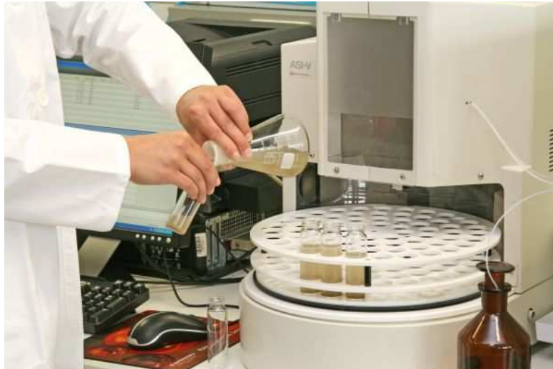
Bild 3: Die Probe wird in ein Autosampler-Probengefäß umgefüllt und die Messung gestartet
