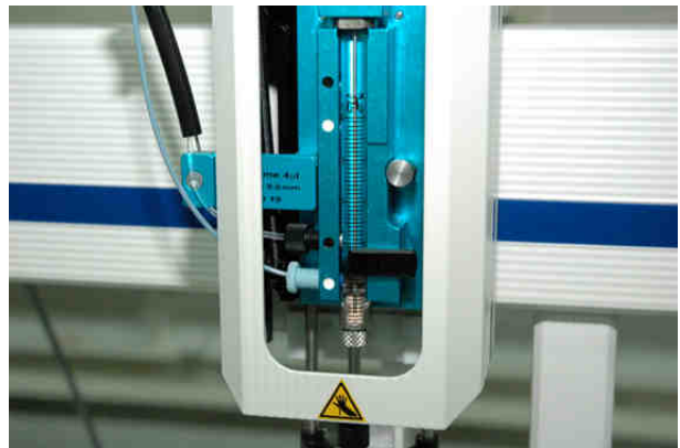
Abbildung 3: Spezielle Spritze für den Transfer der Probe von der LC zur GC
