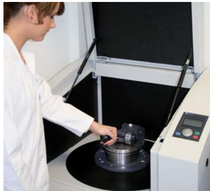
Schwingmühle RS 200 im Einsatz
